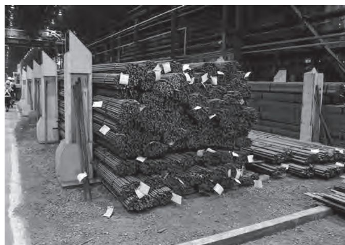
Des correctifs ont été apportés à l'usine d'ArcelorMittal à Longueuil et les piles de fardeaux problématiques sont maintenant mieux soutenues pour éviter qu'elles ne s'effondrent comme lors de l'accident dont a été victime Ian Lavoie.
